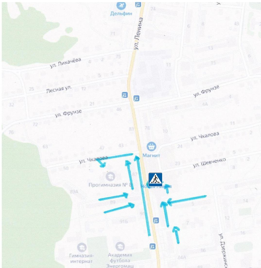
**План-схема пути движения транспортных средств и детей при проведении дорожных ремонтно-строительных работ вблизи образовательной организации**
